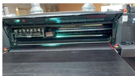
Pour imprimer une série de plans d'évacuation au format A4, conformément à une commande de la Communauté européenne, nous utilisons la Zund Cutter pour découper les plans d'évacuation.
